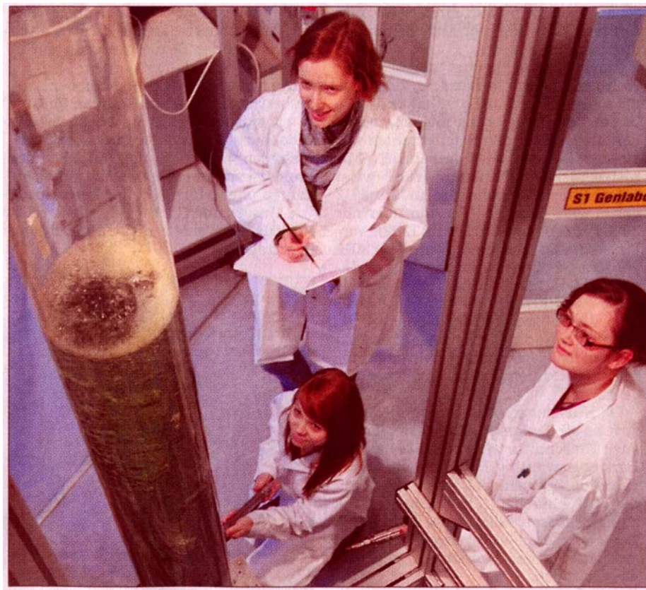
Praktikantinnen: Hannah Hunkler, Felicitas Schmitz und Marina Schäfer (von links) kontrollieren die Sauerstoffversorgung von Mikroorganismen in einem Bioreaktor. TU
